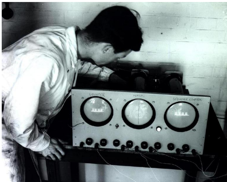
ЭЛТ-монитор, используемый в ЭВМ EDSAC.
